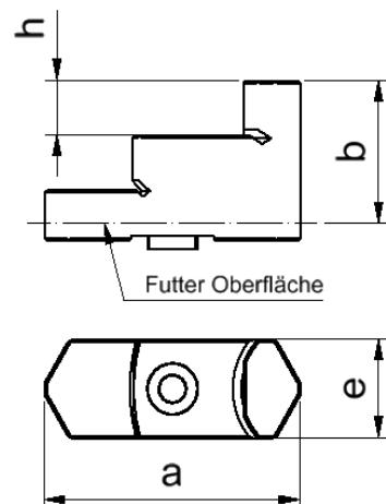
Grundbacken-Satz, dient als Basis und Schnittstelle für die Aufsatzbacken
