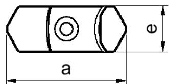
Grundbacken-Satz, dient als Basis und Schnittstelle für die Aufsatzbacken
